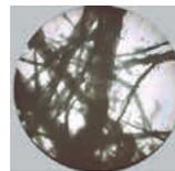
Um über Jahrzehnte hinweg eine konstante Dämmleistung zu erbringen, ist es wichtig, dass der Dämmstoff seine Form und sein Volumen behält. Beim Einblasen von STEICOzell kommt es zu einer dreidimensionalen Verzahnung und Verkrallung der einzelnen Holzfasern untereinander (Mikroskopaufnahme). Selbst bei geringen Rohdichten wird dadurch ein höchstes Maß an Setzungssicherheit bei hoher Elastizität garantiert.
