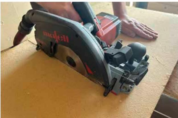
Auf eine ausreichende Absaugung ist bei allen zerspannenden Bearbeitungen zu achten.
