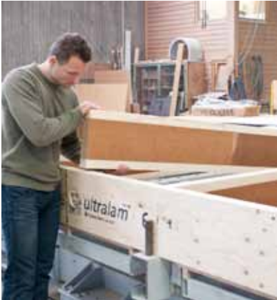
Vorfertigung von Wandelementen mit STEICOultralam R™ und STEICOWall.
