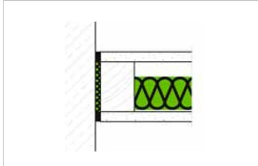
EINBAU STECKDOSE MIT GIPSMÖRTEL
