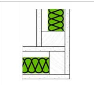
ANSCHLUSS AN MASSIVBAUTEIL
