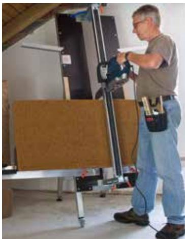
směru. Izolace STEICOflex 038 lze snadno řezat nožem na izolaci, přímočarou pilou nebo elektrickou ocaskou (s pilkovým nožem). Podrobnější informace najdete na internetových stránkách:
