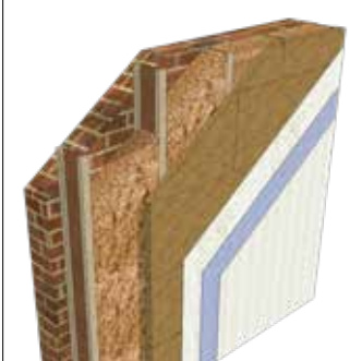
Mauerwerk mit zusätzlicher Gefachebene (Holzunterkonstruktion)
