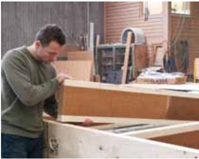
prefabbricazione di elementi a parete tramite STEICO LVL R e STEICOwall.
