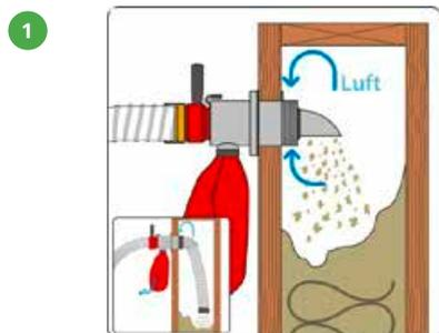
Die entlüftete Drehdüse wird in eine passgenaue Einblasöffnung gesetzt, die mit einer Lochsäge hergestellt wird. Das Element wird aufgefüllt...
