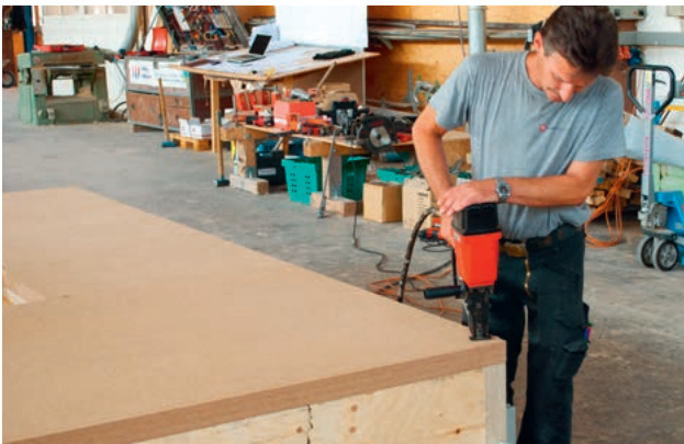
Befestigung von STEICOprotect H mit Edelstahl-Breitrückensklammern
