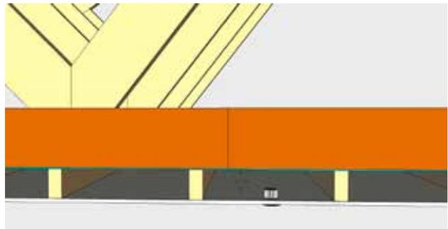
Une solution alternative en rénovation consiste à, quelle que soit la nature des spots encastrés, des capots de protection doivent être mis en œuvre sur chacun d'eux avant la réalisation de l'isolation (Figure 4). Les transformateurs associés doivent être couverts par ces mêmes capots ou sortis de la couche d'isolation.
