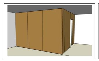
Au fur et à mesure de la pose des panneaux STEICOisorel les axes des montants sont repérés pour permettre la fixation des panneaux et des plaques de parement à venir. Un jeu de un centimètre est ménagé entre les murs périphériques, le plancher et le plafond.
