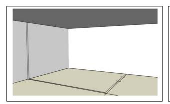
Les surfaces verticales et horizontales sont nettoyées à sec. Les aspérités sont grattées pour offrir une surface plane aux éléments d'ossature. Le tracé de l'emplacement des l'ossature est réalisé à l'aide d'un cordeau à tracer ou d'une règle avec un crayon de traçage.
