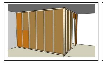
L'isolant semi-rigide STEICOflex est mis en œuvre avec une légère surcote pour permettre un maintien entre les montants. Cette surcote est comprise entre 5 et 15 mm. Les isolants semi-rigides STEICO ne se tassent pas dans le temps si les conditions de mise en œuvre sont respectées. L'épaisseur des panneaux isolants est inférieure ou égale à la profondeur des montants pour ne pas faire pression sur les plaques de plâtre et de parement.
