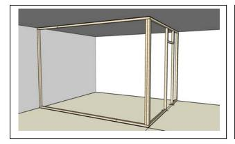
Mise en place des angles et montants d'ouverture. La fixation dans les lisses peut être réalisée par vissage, pointage, ou équerres métallique.
