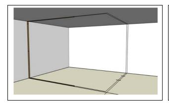
Si la dalle ou la chape est récente il est conseillé de mettre en œuvre une bande résiliente en partie basse avant de poser les bandes Phaltex. Les bandes sont simplement posées. Un point de Mastic Colle STEICO*protect* peut être utilisé pour éviter que la bande ne bouge pendant la suite des opérations. Les bandes sont coupées à l'aide d'une égoïne ou d'un couteau.
