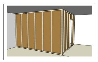
La pose complète sur une face est conseillée pour faciliter la mise en œuvre de l'isolant semi-rigide entre les montants. Un jeu de un centimètre est ménagé entre les murs périphériques, le plancher et le plafond. Au fur et à mesure de la pose des panneaux STEICOisorel les axes des montants sont repérés pour permettre la fixation des panneaux et des plaques de parement à venir.
