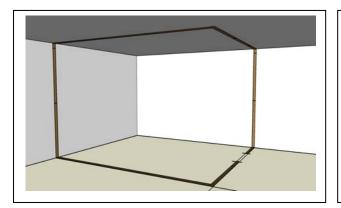
Les bandes sont posées sur toute la périphérie pour assurer une parfaite rupture avec le support. Cette solution est traitée dans les DTU depuis de nombreuses années pour garantir la performance acoustique entre les pièces et les étages.
