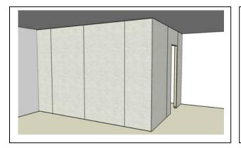
Cette cloison offre un confort acoustique indéniable. Elle participe également au confort hygrothermique des pièces par sa grande capacité de régulation hygrométrique. Cette cloison de 100mm hors tout, par ses seuls produits à base de bois, stocker presque un litre d'eau sans se détériorer.
