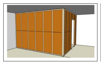
Avant la pose de l'ensemble des panneaux isolants, les gaines électriques ou les conduites d'eau doivent être posées dans l'ossature. Les montants en bois peuvent être percés. Les gaines passent idéalement au milieu de la cloison pour pouvoir être englobées par l'isolant. L'isolant peut être taillé pour laisser la place aux boitiers électriques adaptés.
