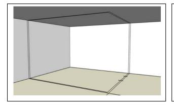
Le tracé est complet avec les positions des ouvertures et si besoin des fixations. Une attention particulière doit être portée à l'aplomb du tracé sur les parois verticales pour assurer une bonne qualité de finition.
