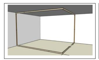
Mise en place des lisses périphériques et fixations suivant les contraintes statiques. Les fixations sont des ponts acoustiques. Il est donc conseillé d'en limiter le nombre au strict nécessaire.
