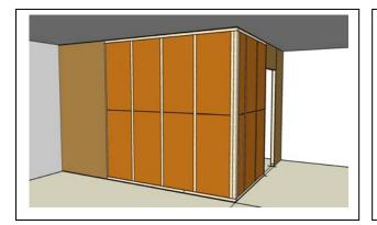
Mise en œuvre des panneaux STEICOisorel sur la contre face. Ne pas oublier de repérer les futurs percements pour les gaines électriques ou les conduites d'eaux.
