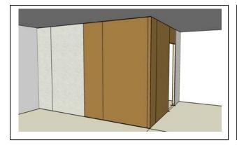
La mise en œuvre des plaques de plâtre est faite à joints décalés par rapport aux panneaux de STEICOisorel. La fixation par vis ou agrafes est conforme aux DTU concernés ou aux prescriptions du fabricant.
