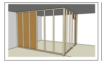
Mise en œuvre des panneaux STEICOisorel. Les panneaux sont posés dans le sens de la hauteur, les joints sont portés sur les montants. La fixation est provisoirement assurée par des agrafes, des pointes ou des vis. La fixation définitive sera assurée par la fixation de la plaque de plâtre dans les ossatures.
