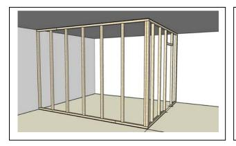
La répartition des montants est fonction des panneaux STEICOisorel ou des plaques de platre de finition qui seront fixées dessus. Les panneaux STEICOisorel ont un format identique aux plaques de plâtre pour faciliter la répartition et la fixation. L'entraxe alors de 60 cm.
