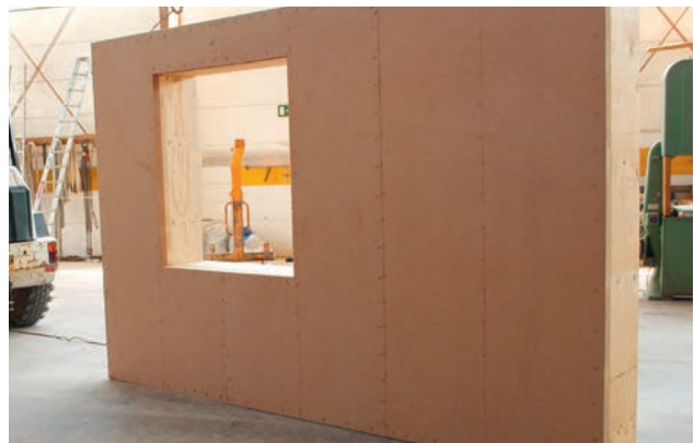
Außenansicht; vor Witterung schützende Wandtafel, bereit für die Baustellenmontage
