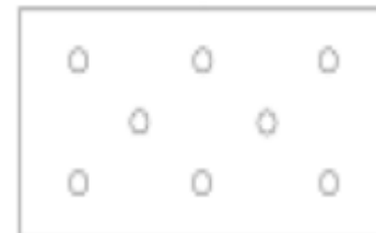
Figure 1b : Panneaux MULTISOL 110 de dimensions 1250 x 600 – plan de chevillage en plein (espacement entre cheville \geq 150 mm)
