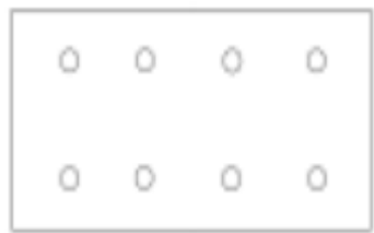
Figure 1b : Panneaux MULTISOL 110 de dimensions 1250 x 600 – plan de chevillage en plein (espacement entre cheville \geq 150 mm)
